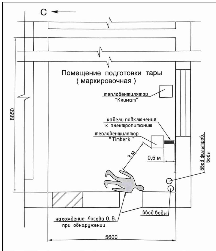
В ходе осмотра «Клима-3» электромонтёрами и было установлено, что теплоаентилятор не пригоден для ремонта и подлежит замене. Электромонтёры произвели его отключение от питающей электрической сети (КЛ 0,4 кВ).
